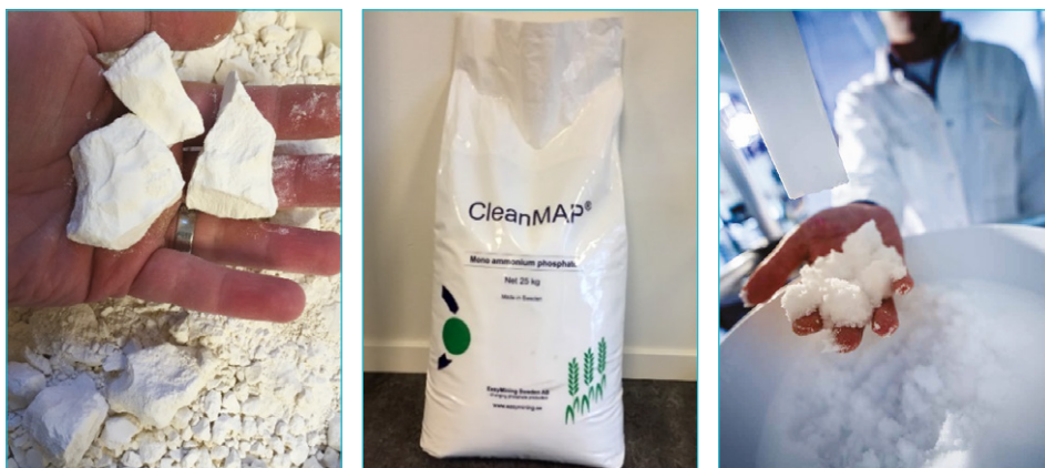
Bild 2: Fotos des Intermediates Calciumphosphat (links) und des Endproduktes Monoammoniumphosphat (Mitte und rechts)
