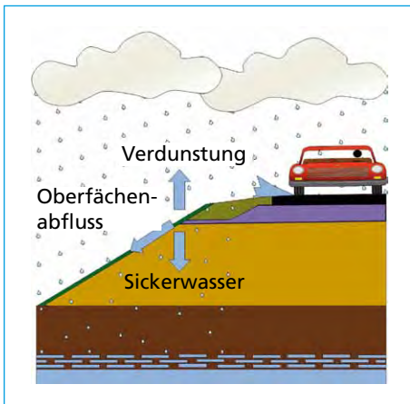
Bild 1: Schematische Darstellung des Wasserhaushaltes an einer Straßenböschung
