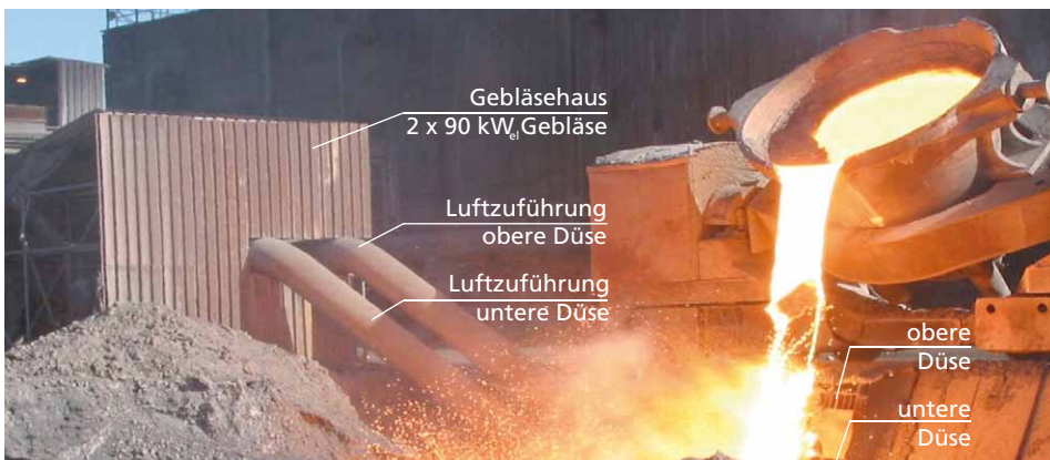
Bild 1: Betriebsversuche zur Luftverdüsung von Stahlwerksschlacke in Deutschland
