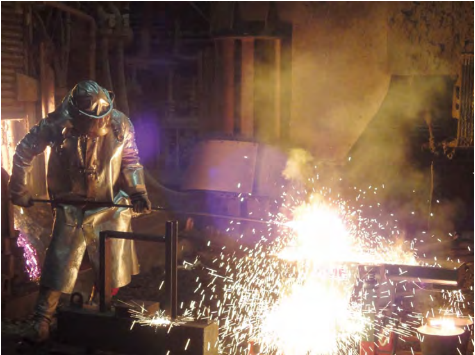
Bild 6: Betriebsversuche zur Wärmerückgewinnung aus Elektroofenschlacke mittels KKRR
