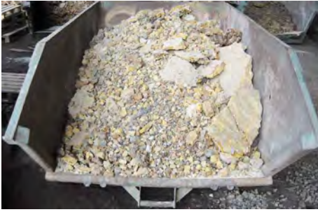
Bild 3: Exemplarisches Beispiel einer im Serienmaßstab mit beschleunigter Abkühlung stabilisierten sekundärmetallurgischen Schlacke
