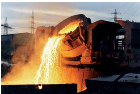
Bild 2: Abguss von Stahlwerksschlacke ins Beet (links) und Aufbereitung zum verkaufsfähigen Endprodukt (rechts)
