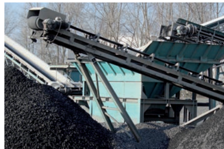
Bild 2: Abguss von Stahlwerksschlacke ins Beet (links) und Aufbereitung zum verkaufsfähigen Endprodukt (rechts)
