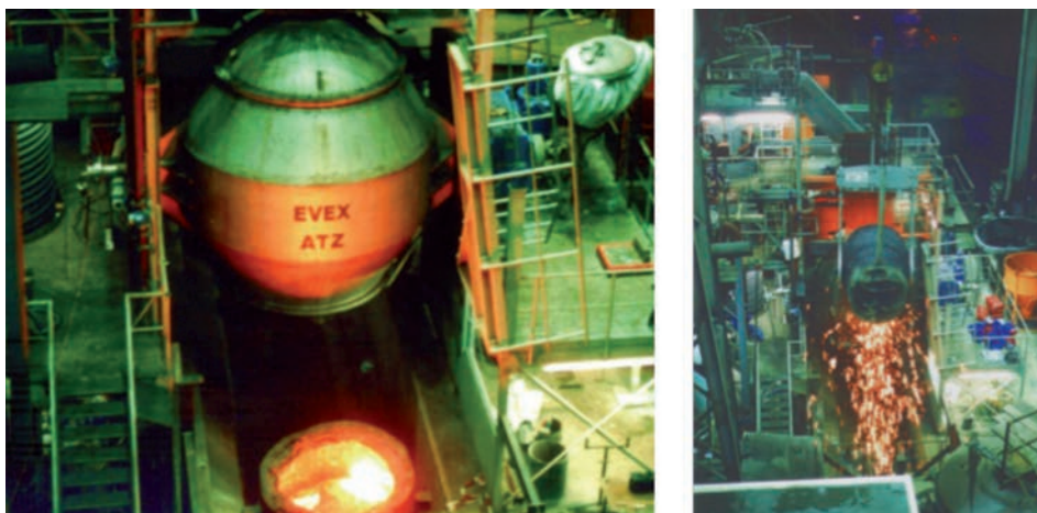
Bild 3: ATZ-Eisenbadreaktor mit Drehkonverter (links) sowie beim Einfüllen von Roheisen (rechts)
