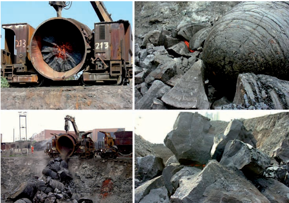
Bild 4: Abkippen von kristallin erstarrter Schlacke und Zerfall in Vorzugsrichtung
