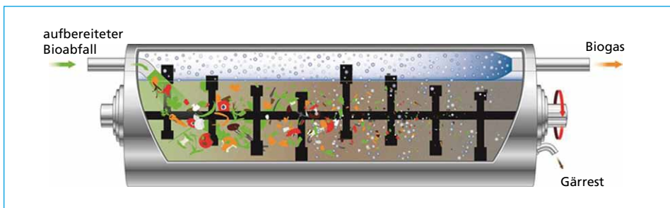
Bild 3: Schematische Darstellung des Kompogas-Pfropfenstrom-Fermenters
