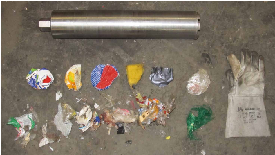
Bild 7: Bohrklein einer Einzelprobe mit Bohrschäfte als Ergebnis der Direkten Ballenbeprobung
