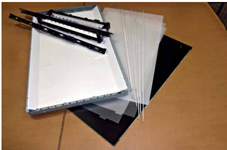
Bild 7: Bestandteile eines LCD-Panels mit flächiger Hintergrundbeleuchtung
