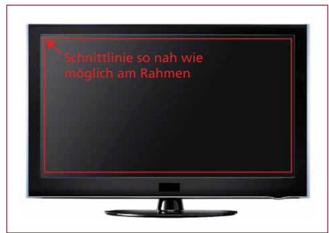
Bild 10: Schnittverlauf bei Geräten mit flächiger Hintergrundbeleuchtung
