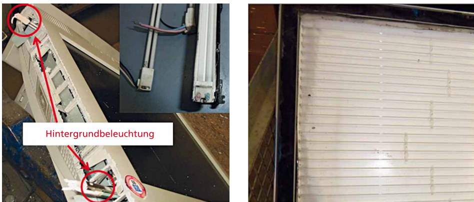
Bild 1: Bauarten von LCD-Bildschirmgeräten mit Hg-haltiger Hintergrundbeleuchtung
