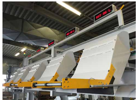
Bild 6: Industrieanlage zur Sortierung von Feuerfestmaterialien auf Basis der LIBS-Elementanalytik
