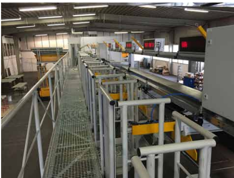
Bild 6: Industrieanlage zur Sortierung von Feuerfestmaterialien auf Basis der LIBS-Elementanalytik
