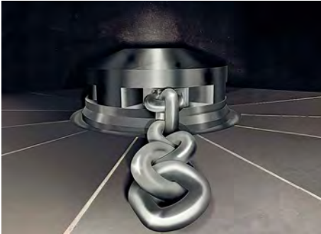
Bild 4: Arbeitsorgan bzw. Beschleunigungselement des QZ in der Grundform
