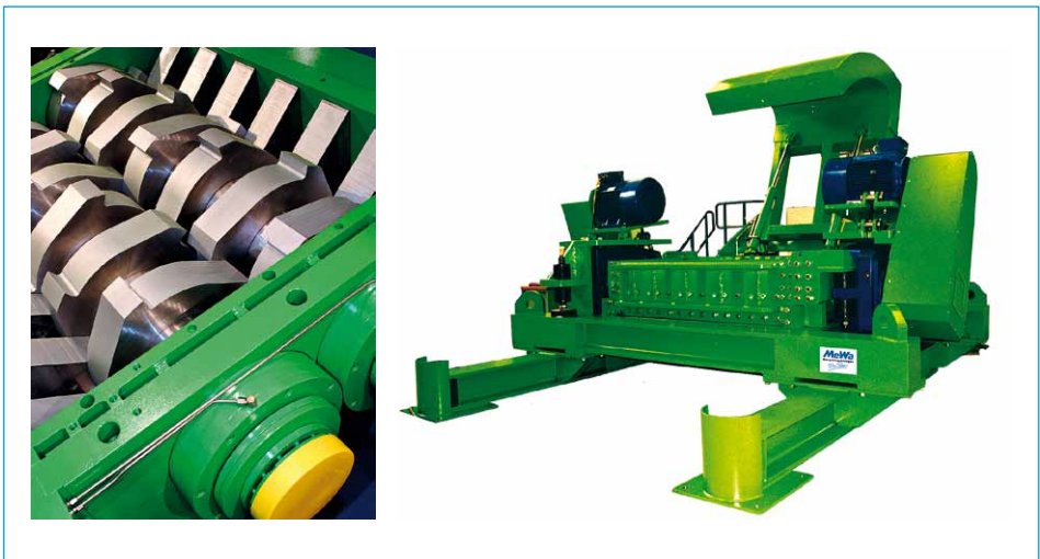
Bild 1: Universal-Zerkleinerer UC 2000 mit Zwei-Wellen-Schneidwerk und hydraulischer Nachdrückeinrichtung (vereinfachte Darstellung ohne Aufgabeschacht)
