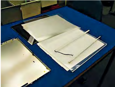
Bild 2 b: Manuelle Zerlegung von Flachbildschirmen (links: Folien und Hintergrundbeleuchtung PC Monitor; rechts: Hintergrundbeleuchtung bei einem TV Flachbildschirm)
