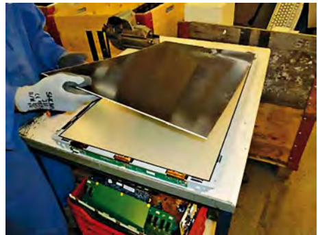
Bild 2 a: Manuelle Zerlegung von Flachbildschirmen (links: LCD Modul; rechts: LCD Panel)
