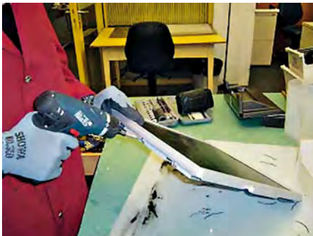
Bild 2 a: Manuelle Zerlegung von Flachbildschirmen (links: LCD Modul; rechts: LCD Panel)
