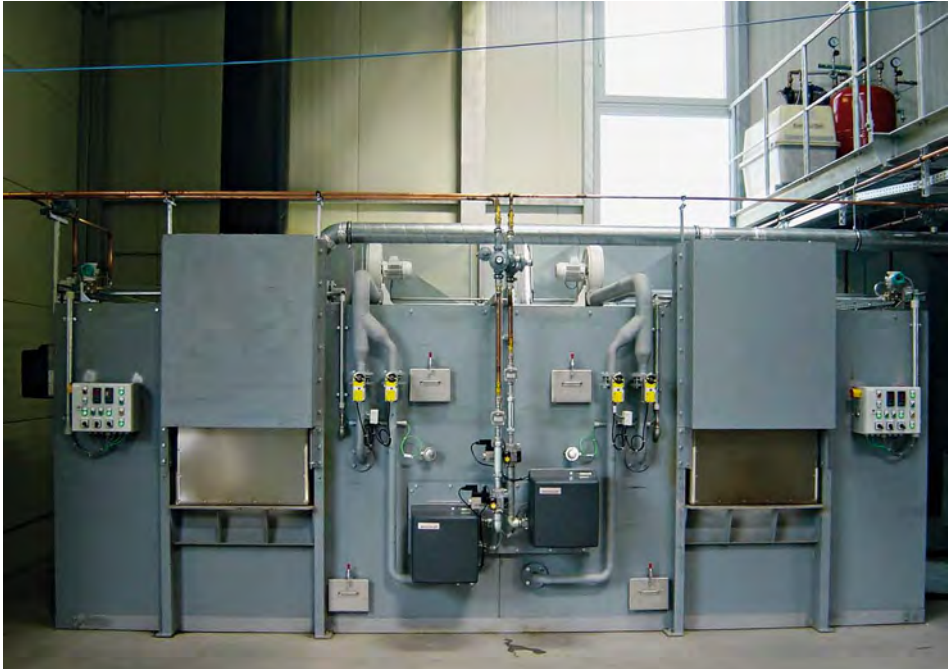
Bild 3: Doppelofensystem zur Gekrätzveraschung
