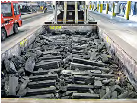
Bild 1: SPL-Ausbruch einer Kathodenwanne der Aluminiumelektrolyse, der für das Forschungsprojekt IEPALT zur Verfügung gestellt wurde (etwa 25 Tonnen)
