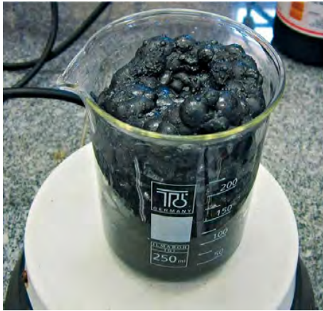
Bild 5: Flotation von Kathodenkohle während der Laugung durch Freisetzung von Wasserstoff
