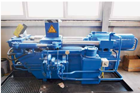
Bild 8: Versuchspresse ArnoBrik der Firma ATM Recyclingsystems GmbH
