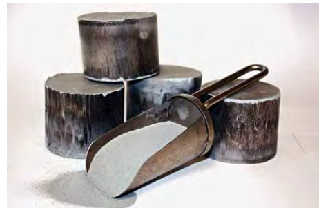
Bild 9: Staubförmiger Produktionsrückstand vor und nach dem Brikettieren
