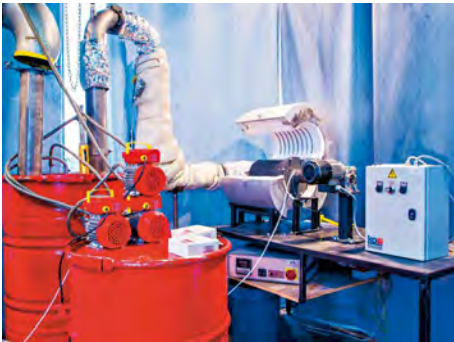
Bild 10: Entwickelte Pyrolyseeinrichtungen in stehender (oben) und rotierender (unten) Ausführung
