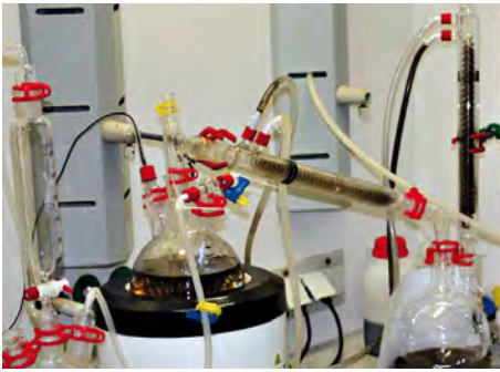
Bild 12: Versuchsaufbau zur Br-Herstellung (links) und gewonnenes Brom aus Prozessabwässern der Pyrolyse (rechts)
