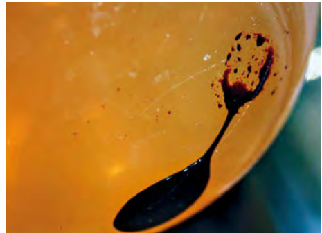
Bild 12: Versuchsaufbau zur Br-Herstellung (links) und gewonnenes Brom aus Prozessabwässern der Pyrolyse (rechts)
