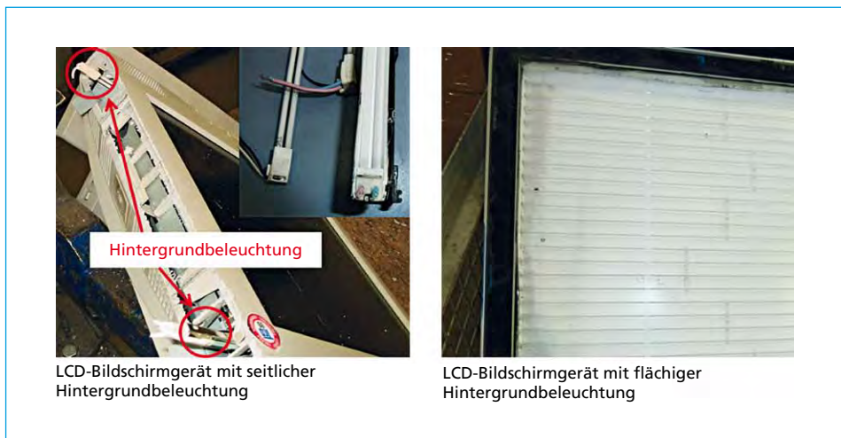
Bild 1: Bauarten von LCD-Bildschirmgeräten mit quecksilberhaltiger Hintergrundbeleuchtung
