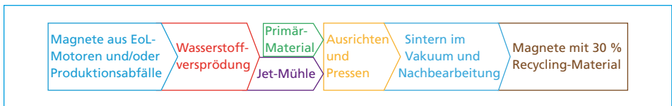
Bild 3: Verfahren für das werkstoffliche Recycling von NdFeB-Magneten
