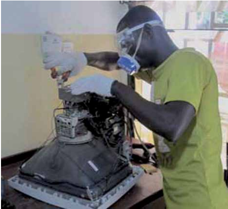
Bild 3: Fachgerechte und umweltfreundliche Zerlegung von Altgeräten in Ghana
