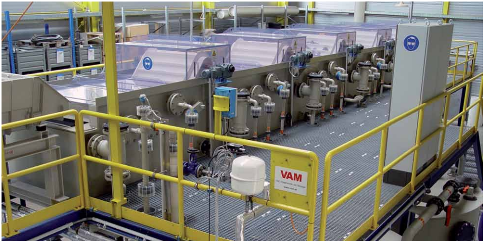
Bild 2: Pilotanlage der CUTEC GmbH zur sauren Entzinkung von Neuschrotten
