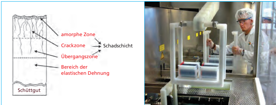
Bild 4: Störung der Waferoberfläche und Durchführung eines Ätzschrittes
