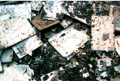
Bild 7: Alugrundplatten und Platintenteile nach der thermischen Vorbehandlung
