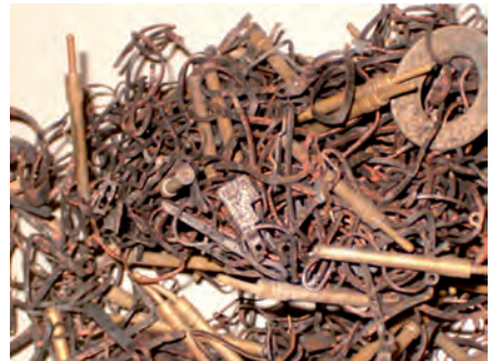
Bild 8: Separierte Leiterbahnen und Stecker-Bauteile aus den Steuereinheiten
