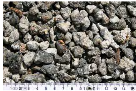
Bild 5: Hausmüllverbrennungssasche – HMVA, Kornklasse 8/16 mm, gewaschen
