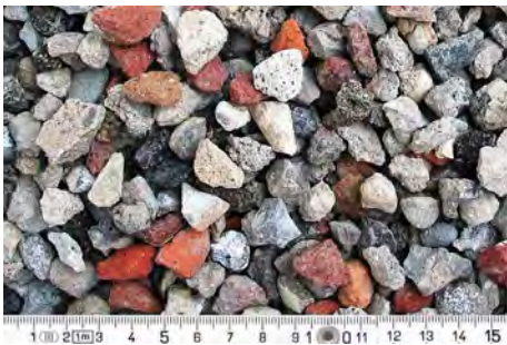
Bild 4: Recycling-Baustoff – RC, Kornklasse 8/16 mm, gewaschen
