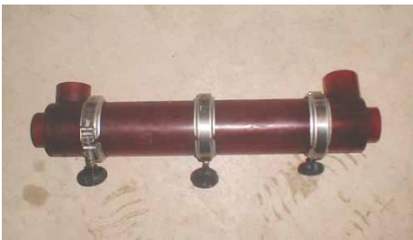
Bild 3: 4-Wege-Gegenstromhydrozyklon aus Polyurethan
