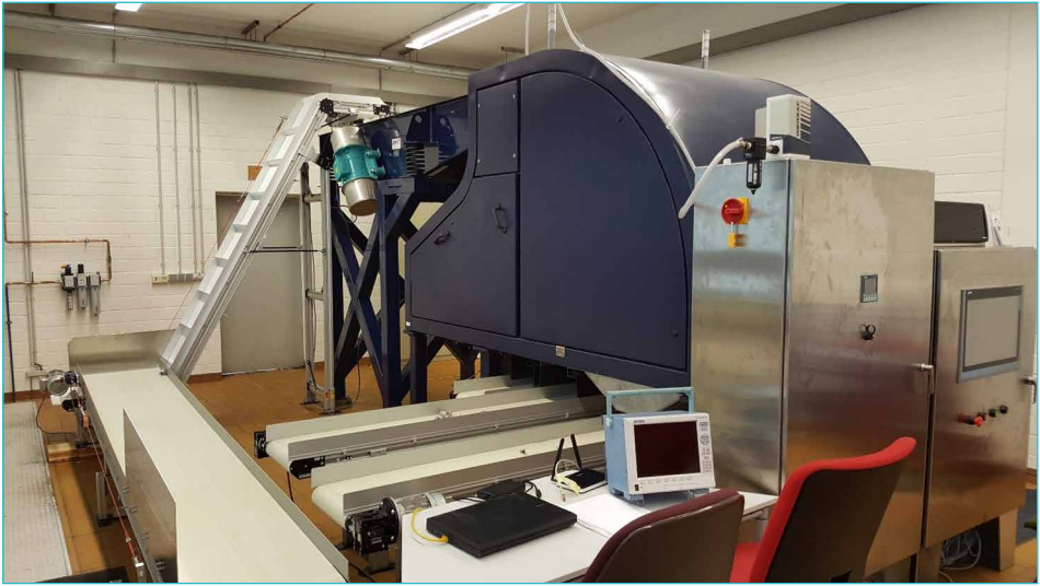
Bild 6: LIBS-System der Hydro Aluminium Rolled Products im F&E Zentrum Bonn
