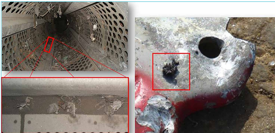
Bild 1: Verbleibewege der Magnete – links: Magnete in der Siebtrommel einer Rostascheaufbereitung; rechts: Magnete im Stahlschrott der Schredder-Schwerfraktion der Automobilverwertung
