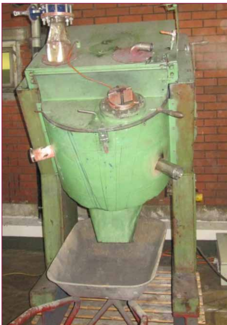
Bild 6: Versuchsapparat alter Eirich-Mischer Typ R7
