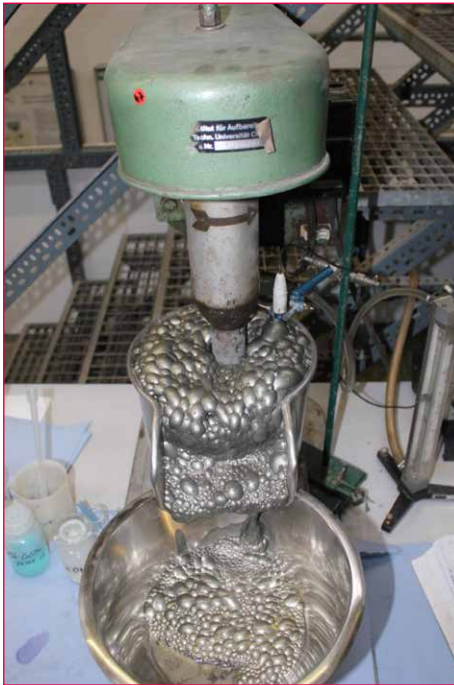
Bild 5: Rührwerk-Laborzelle Denver 3L, Sulfidkonzentrat für Laugeversuche, IFAD, Januar 2017
