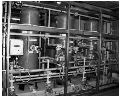
Bild 3 b: Selektiv-Ionenaustauscher zur Bindung von Quecksilber
