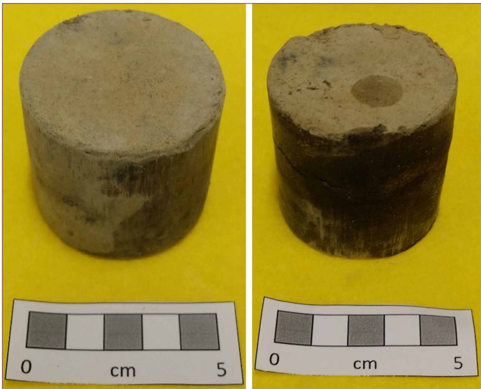
Bild 3: Briketts (erzeugt bei 7.200 bar) eines neuen Steinwolle-Produkts mit Carboxymethylcellulose (links) und Melasse (rechts)
