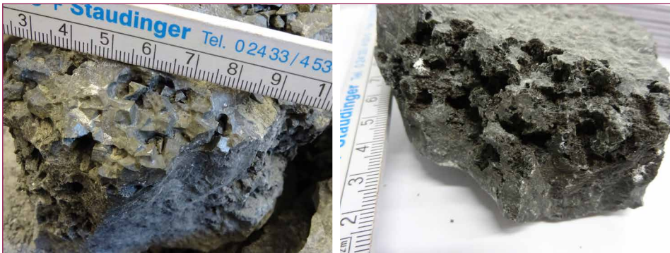
Bild 6: Kristalle im erstarrten Schmelzbad nach langsamer Abkühlung im Lichtbogenofen; links kubische Kristalle aus dem oberen Bereich der Schlackeschicht; rechts kleinere Kristalle aus dem Zentrum der Schlackeschicht
