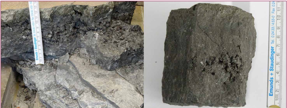
Bild 5: Erstarrtes Schmelzbad nach langsamer Abkühlung im Lichtbogenofen; links mit Metallphase; rechts Profilansicht der Schlacke
