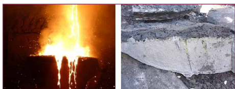
Bild 7: Teilreduzierte EOS Elektrolichtbogenofenschlacke und Metallregulus
