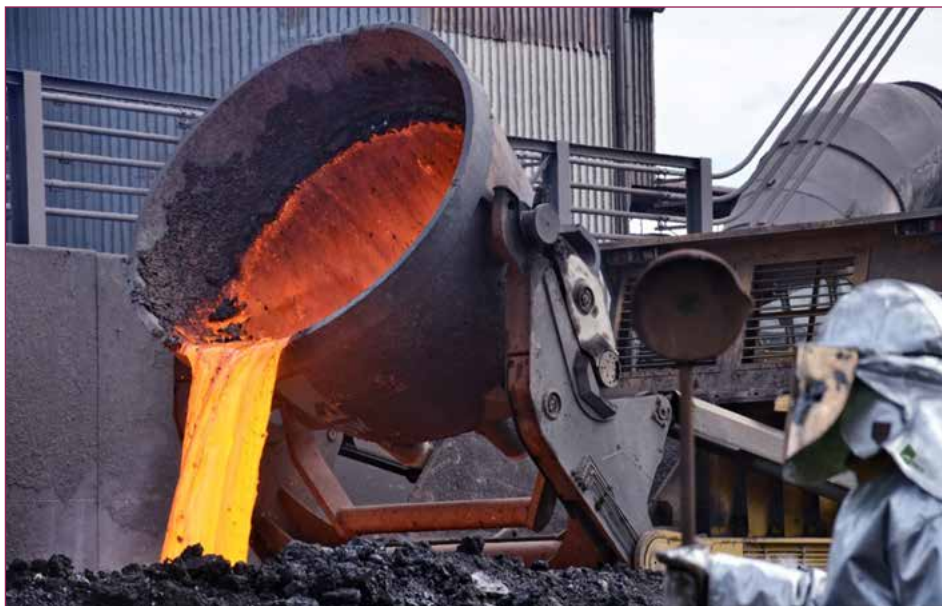
Bild 1: Probennahme direkt im Schlackenbeet im Rahmen der Charakterisierung der Elektroofenschlacke nach Optimierungsmaßnahmen
