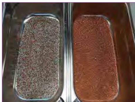
Bild 4: Ausgangsmischung Ziegel/Gips (links), Ziegelfraktion nach Aussortieren der Gipsfraktion (rechts)
