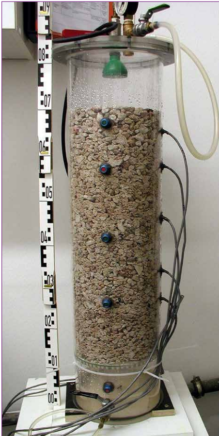
Bild 2: Säulenreaktor mit Rezyklatgemisch
