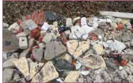
Bild 1: Unerlaubter Wegebau im ländlichen Raum mit unsortiertem Bauschutt
