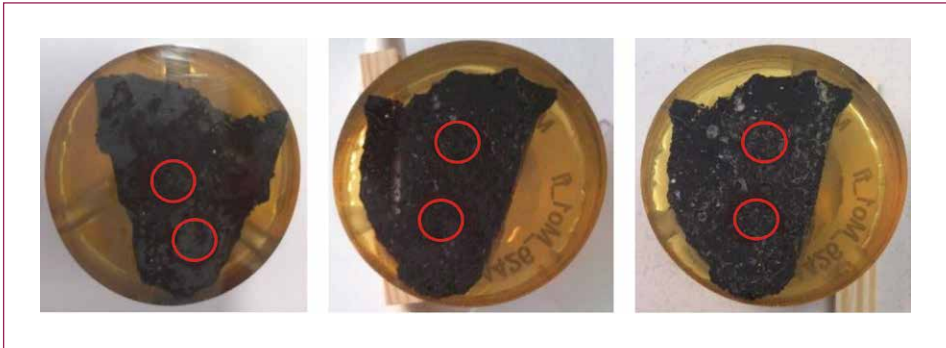
Bild 1: Anschnitte der Probe EOS_BM; von links nach rechts: nicht für den Auslaugversuch, vor dem Auslaugversuch und nach dem Auslaugversuch
