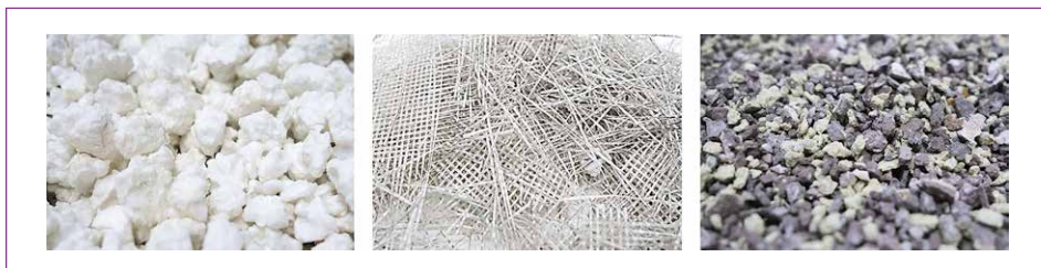
Bild 8: EPS, Armierungsgewebe sowie Putze und Kleber nach der Aufbereitung
