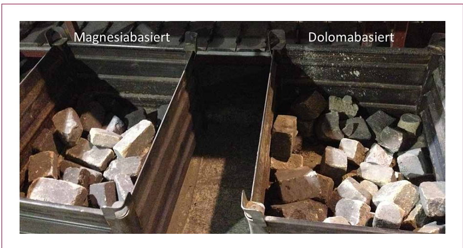
Bild 6: Zwei Produkte der Sortierung mittels LIBS
