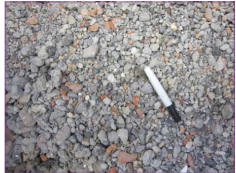
Bild 4: Mittels NIR-Technik gereinigte Mineralikfraktion
