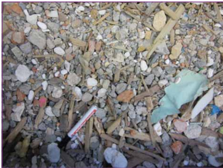
Bild 3: Ausgeschossene Störstofffraktion mit u.a. Holz und Gips
