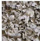
NE-MIX 0-100 Kundenmix Nichteisenmetall- Konzentrate mit Korn- grössen 0-100 mm aus Kundenanlagen wie KVA und externen Aufbereitungsanlagen
