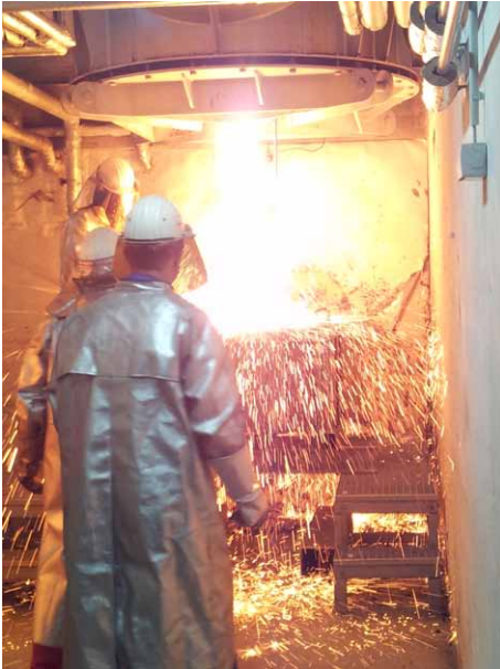
Bild 6: Abstich an der Pilotanlage
