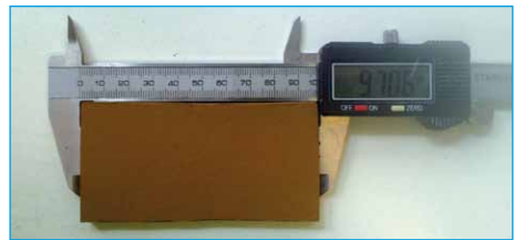
Bild 4: Keramikprobekörper aus trocken ausgetragener Feinschlacke < 1 mm
