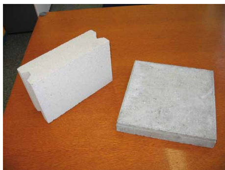
Bild 2: Anwendung von grober MVA-Asche in Beton (Granova von Heros am Sluiskil)
