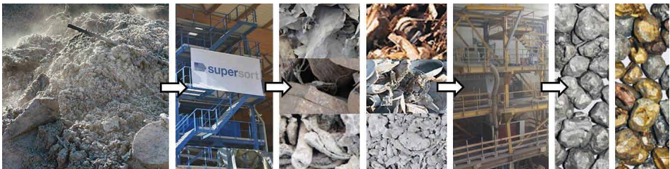
Bild 1: Rückgewinnung der Metalle aus der Schlacke; von links nach rechts: Schlacke nach Abfallverbrennung, Ausschnitt der Recyclinganlage, verschiedene Metallfraktionen aus der ersten Verarbeitungsstufe, Ausschnitt aus Anlage zur Veredelung, hochwertig veredelte Metallprodukte.
