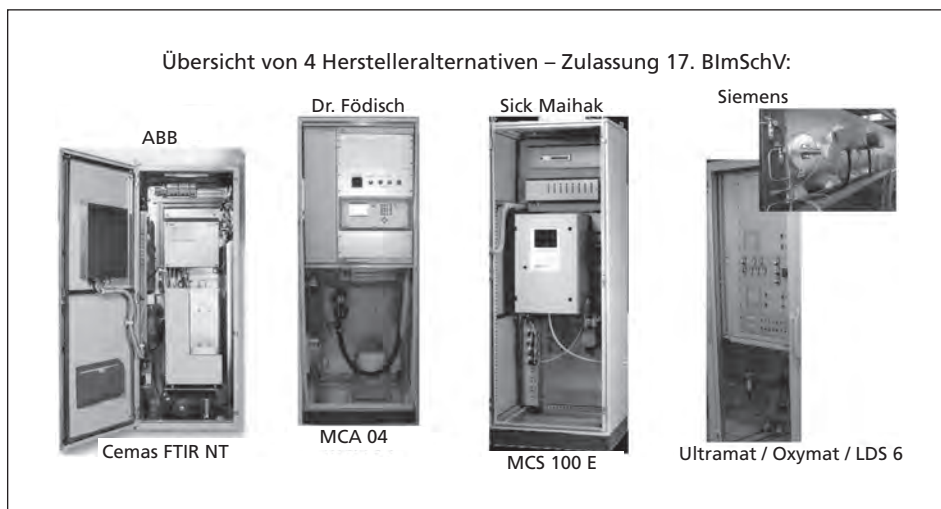
Bild 1: Verschiedene Systeme für Messeinrichtungen nach 17. BImSchV
