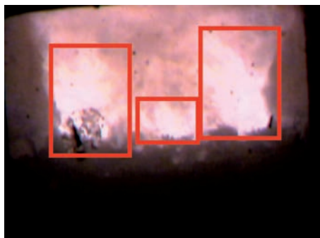
Bild 4: Aufnahme des Feuerraumgeschehens zum Zeitpunkt x plus 0 Minuten Kennzeichnung der Flammenmaxima
