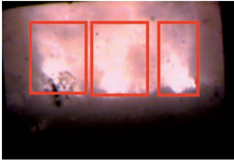
Bild 5: Aufnahme des Feuerraumgeschehens zum Zeitpunkt x plus 1 Minute; Kennzeichnung Flammenmaxima, jedoch noch keine geschlossene Front
