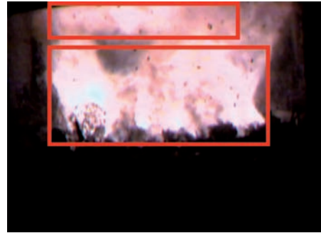
Bild 6: Aufnahme des Feuerraumgeschehens zum Zeitpunkt x plus 2 Minuten; Kennzeichnung Flammenmaxima, geschlossene Front unterer roter Rahmen; Sekundärluftdüsen als Fackeln im oberen roten Rahmen
