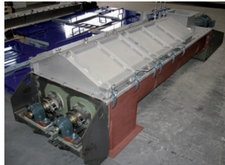
Bild 6: Anfeuchtemischer zur Rezirkulation
