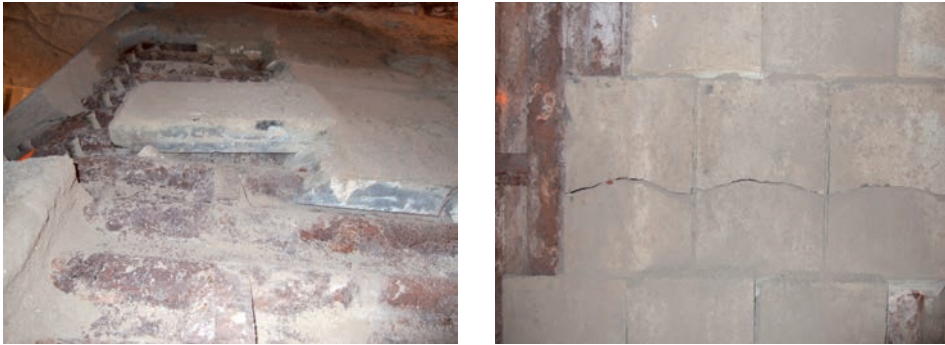
Bild 6 und Bild 7: Folge der Volumenausdehnung von SiC-Werkstoffen in dem Abfallkessel
