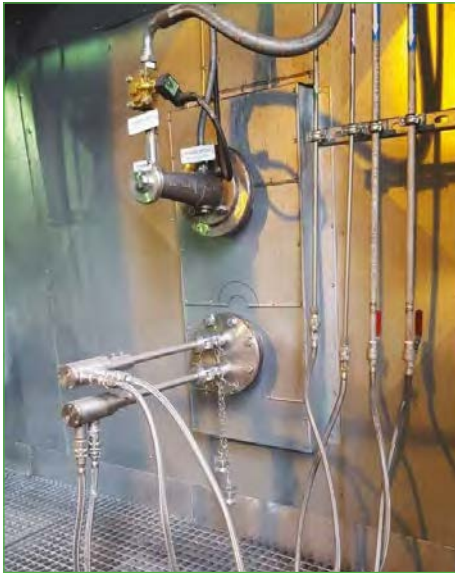
Bild 6: Berührungsfreie Temperaturmessverfahren – akustisch (links), optisch (rechts)
