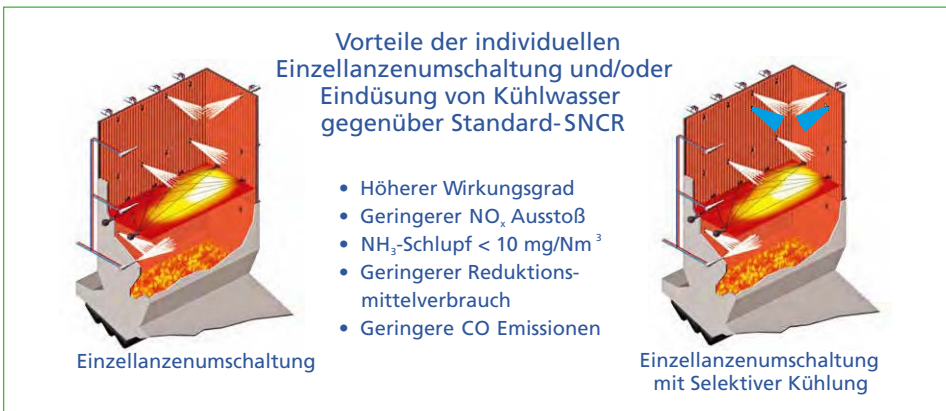
Bild 3: Einzellanzenumschaltung mit und ohne Selektive Abgaskühlung vs. Standard-SNCR
